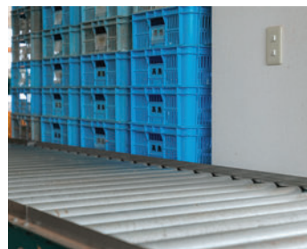
ローラーコンベアにより重コンテナの移動、搬出が容易に
