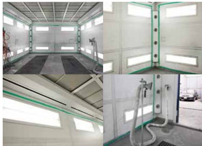
クリーンな空気を保つ「水性対応プッシュプル型塗装乾燥ブース」
