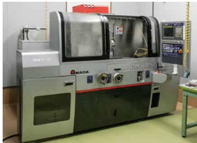
砥石の成形から加工まで全自動で行うCNC精密成型研削盤
