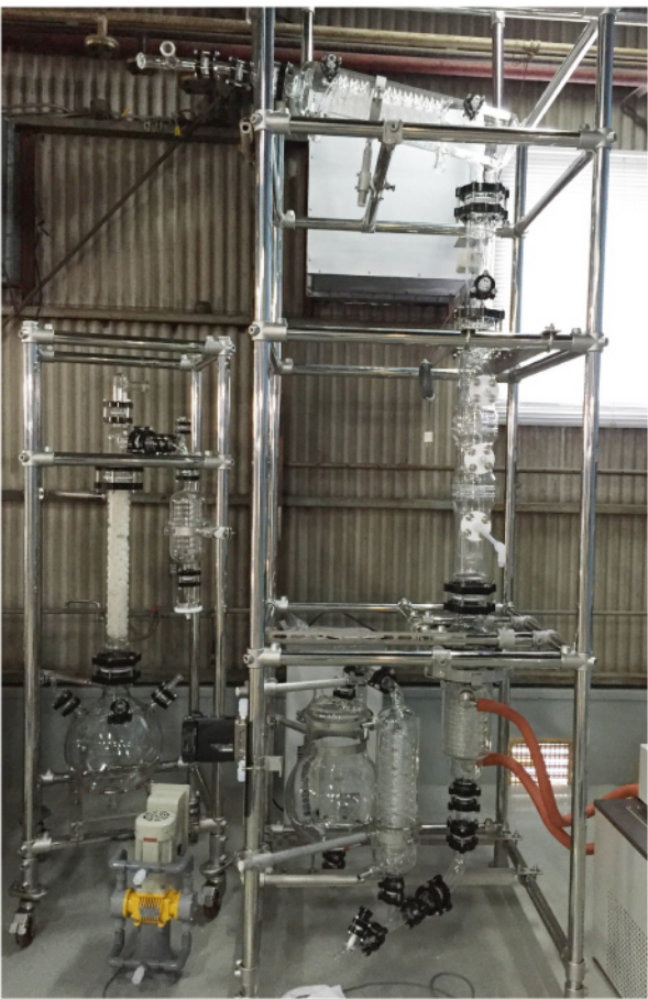
▲今回開発した濃縮カプサイシン類の製造用ガラス装置
