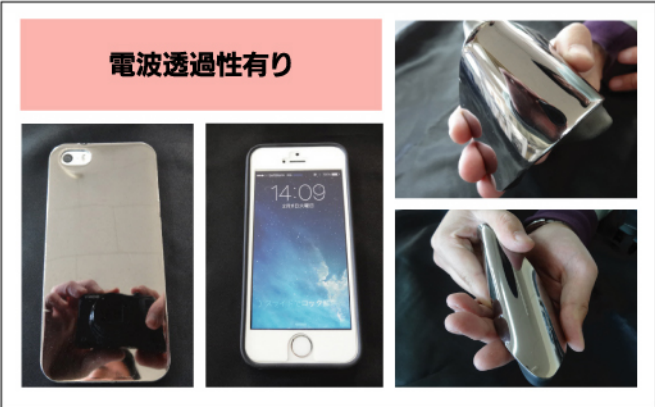
▲ラバーへの塗布も可能で、曲げても膜は割れない
