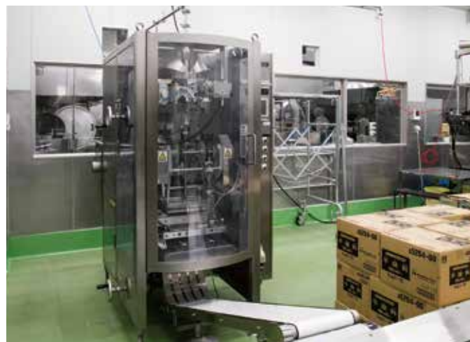
印字や容量調整が可能な充填機
