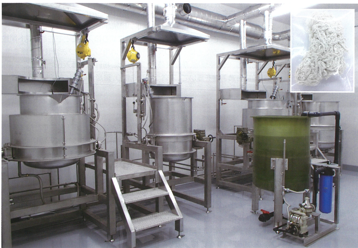
▲補助金を活用して導入したサクラン抽出処理のためのライン。右上は抽出されたサクラン
