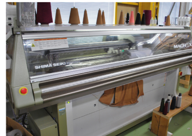
▲今回導入したホールガーメント自動横編み機。編み機の中央部に見える茶色の製品が、立体的に編成されたニットウェア
