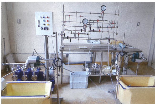
▲今回導入した乳化剤なしで水と油を混合できるSPG透過膜乳化装置
