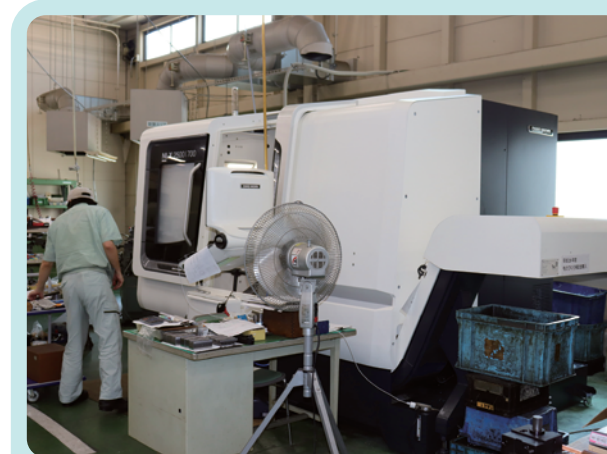
導入した3DCADのデータを活用して丸物部品加工
