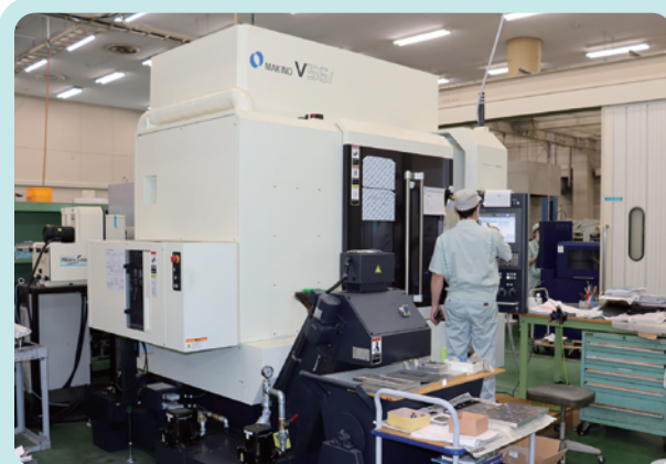
導入した3DCADのデータを活用してマシニングセンターで3D加工
