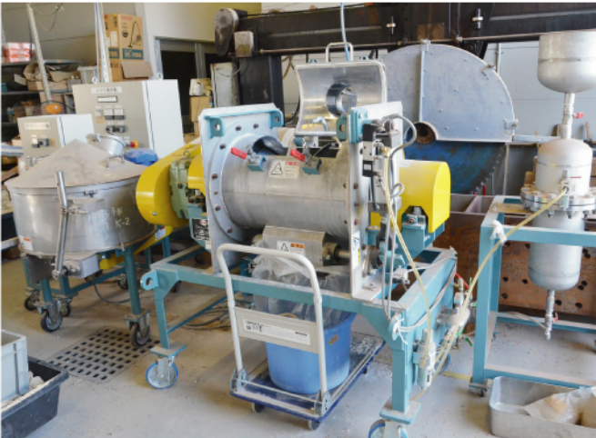
▲マグエンと自然素材をかく拌・混合する装置
