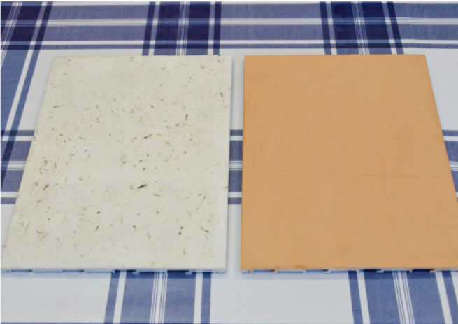
▲強い吸着力でアルミ板にもそのまま塗布できる
