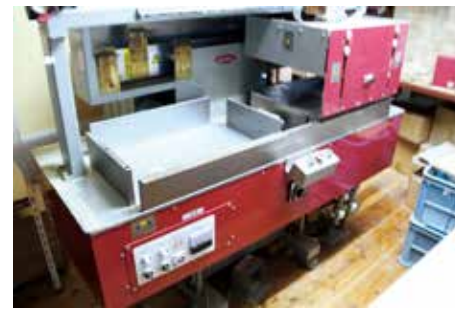
接合部の糊を乾燥させる高周波木箱接着機
