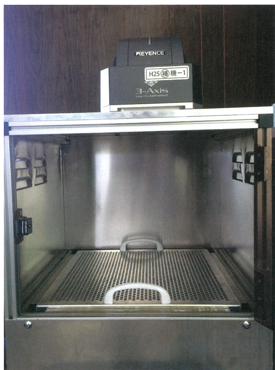
大分海苔をレーザーカッティングする加工機
