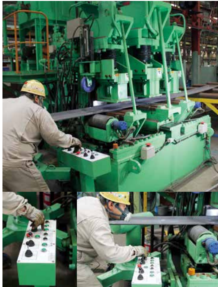
300tフレームベンダーで作業効率は大きく高まった
