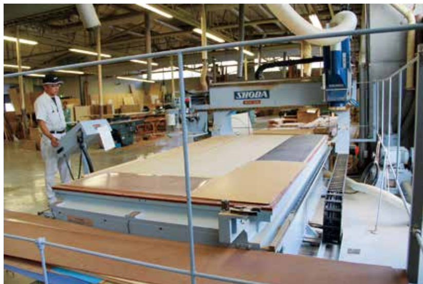
順調に稼働する木工専用NCルーター
