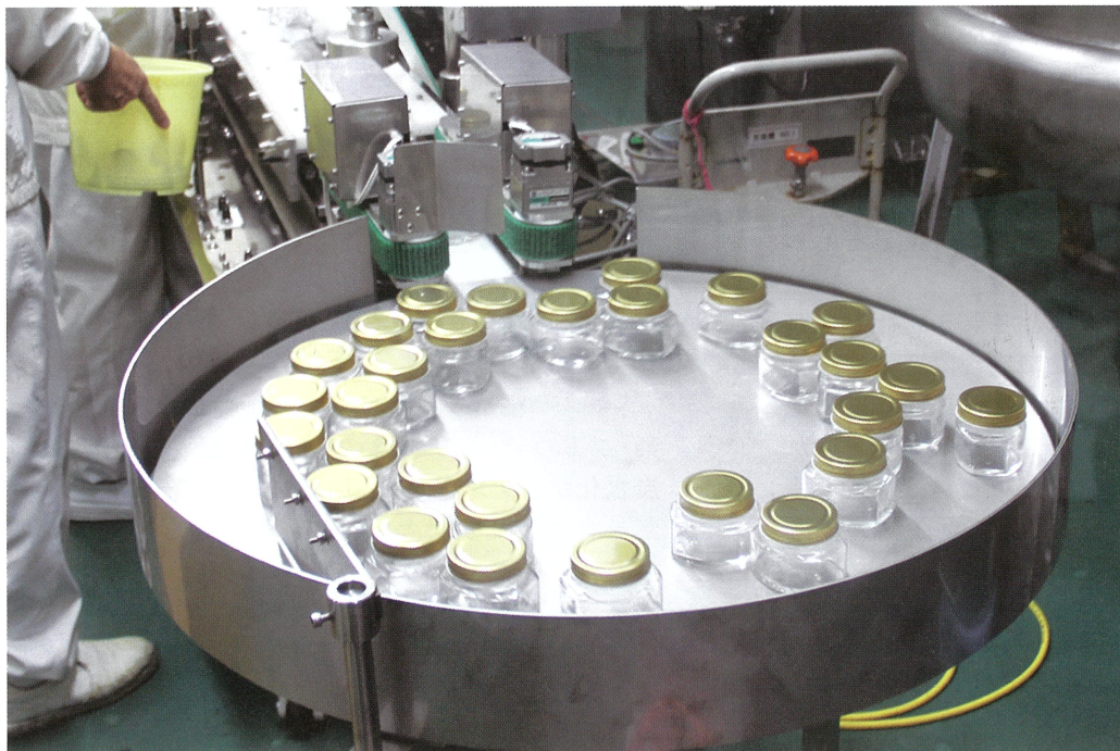
自動化されたターンテーブル式充填機は大量生産、コスト削減だけにとどまらず、商品開発に対するモチベーションも高めた
