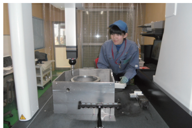
三次元測定機にて製品検査中
