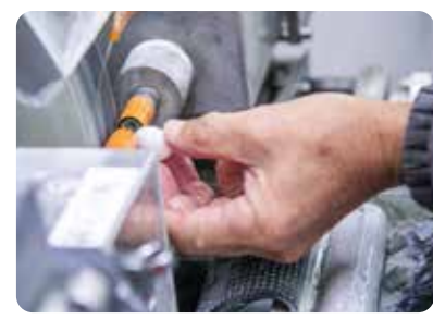
碁石の“ミミ”を丸くする「ハビキ」工程は製品の質を左右する重要な工程。改良型ハビキ機を導入することで製品の精度が安定しました。
