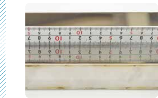
これまでのTIG溶接（上）とYAG溶接（下）で仕上げられた製品。YAG溶接品には熱歪みや溶接による変色がほとんどありません。
