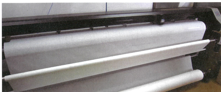
インクジェットプロッターによる衣装パターンの印刷
