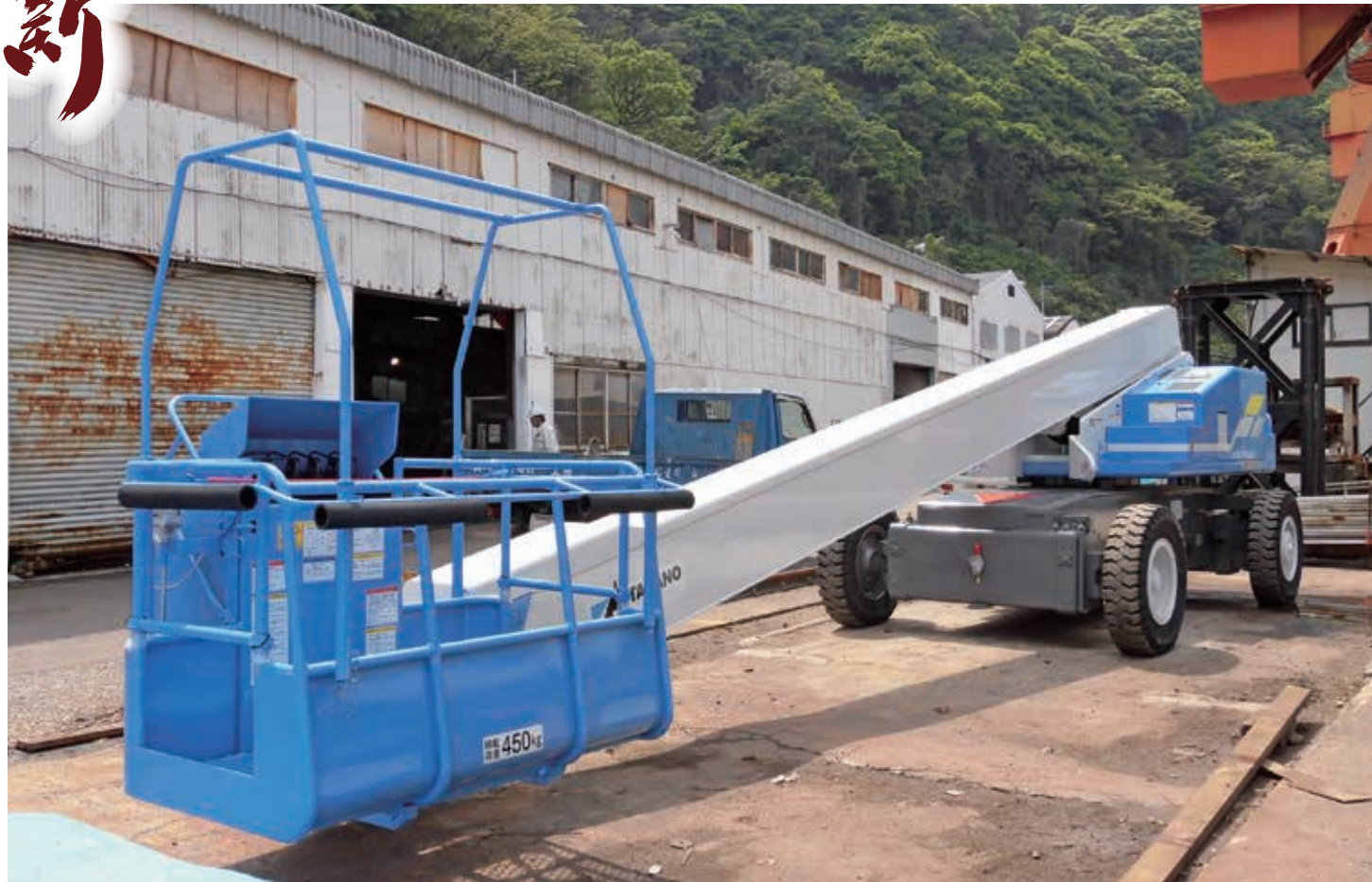
導入した高所作業車
