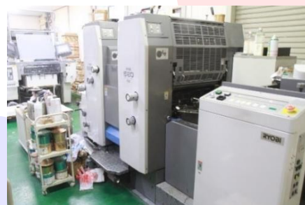
工場に設置したオフセット印刷機
