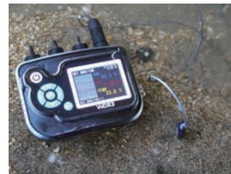
河川での防水実験の様子
