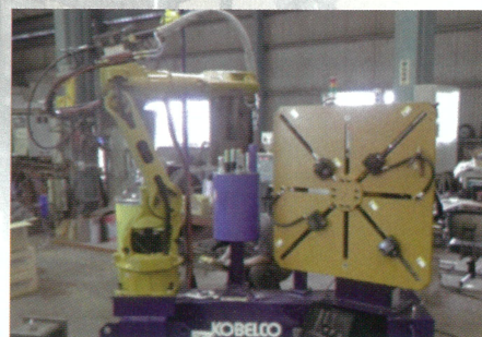
導入した鉄骨溶接ロボットシステム
