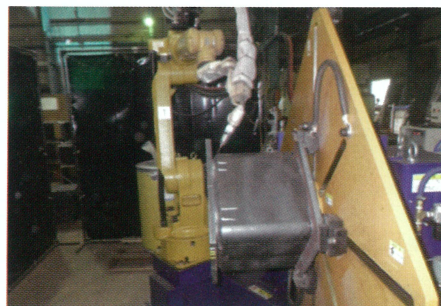
鉄骨溶接ロボット
