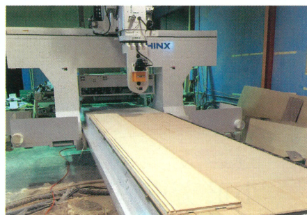
NC ルーターによる4mサイズのパネル加工
