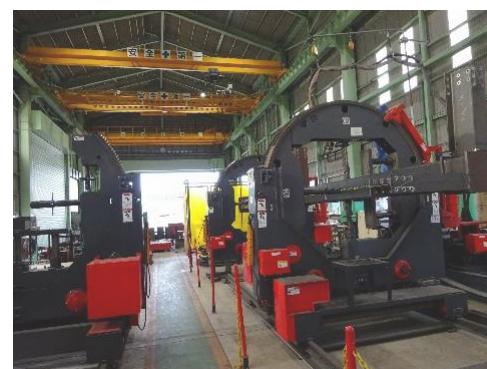
溶接ロボット群
