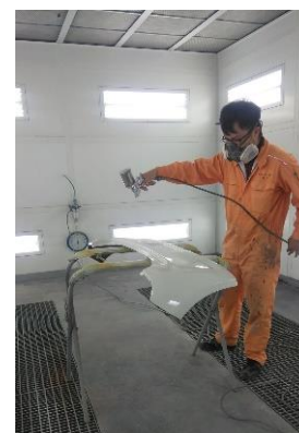
塗装ブース内での作業の様子
