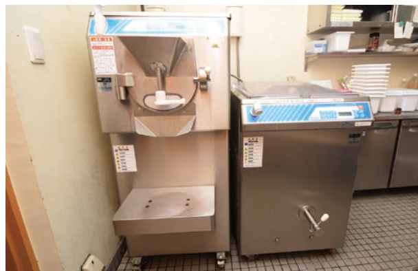
生産量が約2倍になったパステライザー（左）とフリーザー
