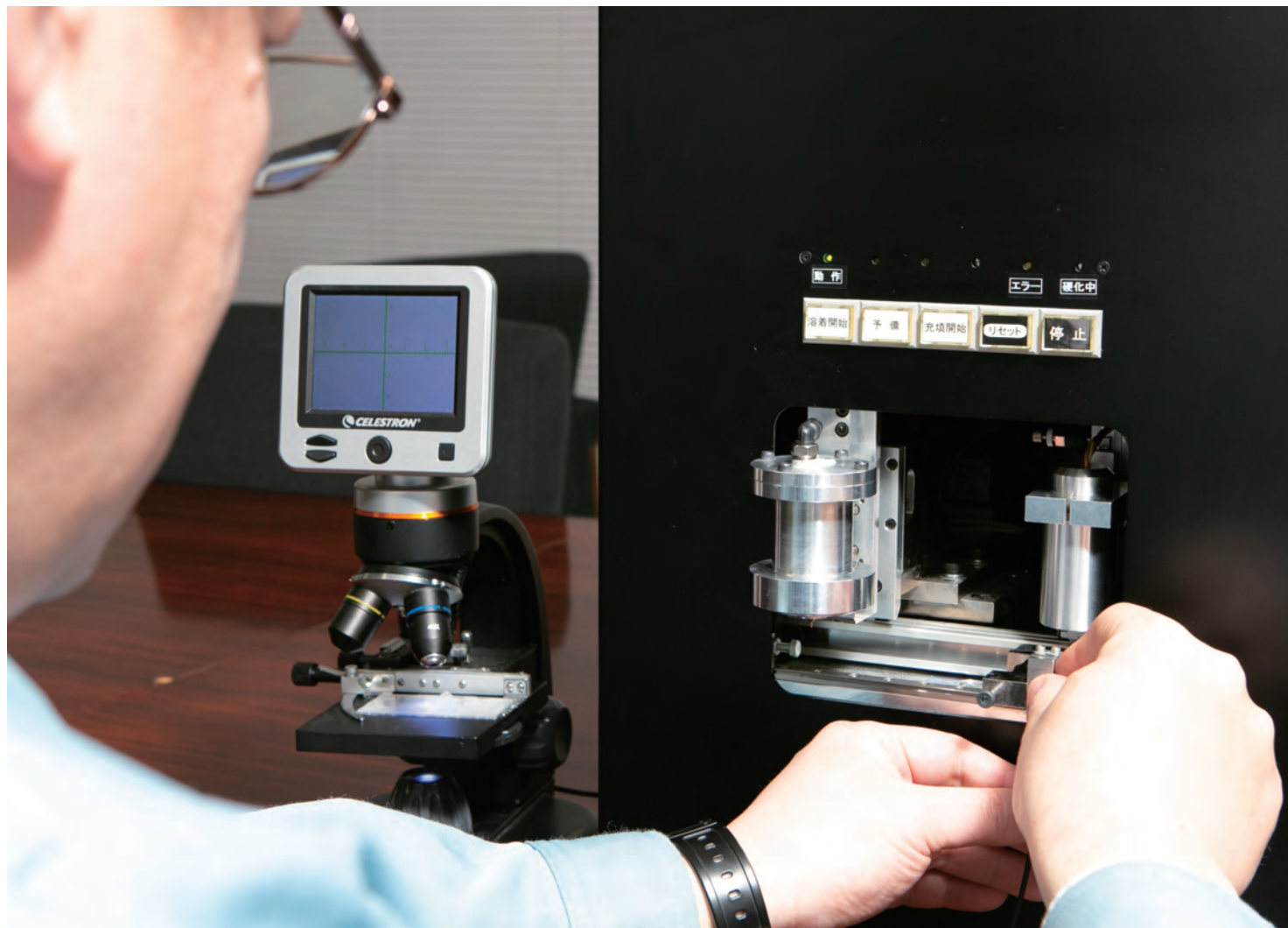
線量計のプローブの先端に機械で自動的にシンチレーター剤を充填
