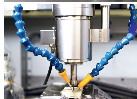
微細加工を可能にする超音波ユニット
