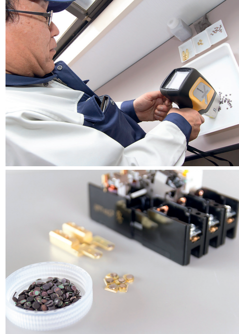
左がブレーカーより抽出した銀
