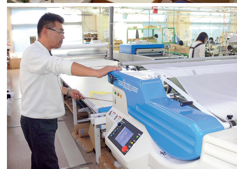
工程の高速化を実現した自動裁断機
