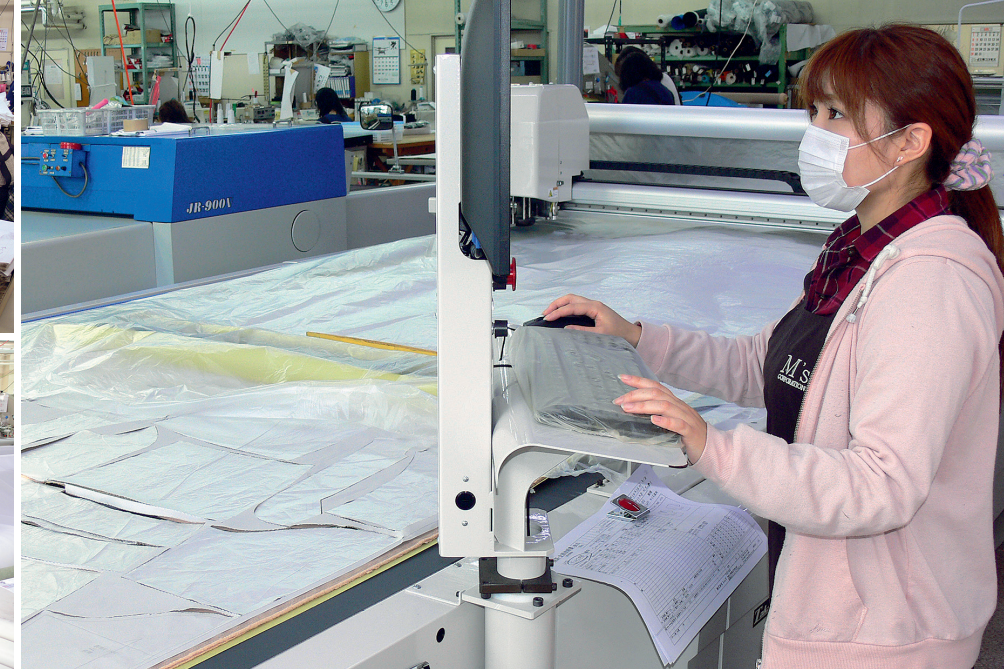
自動延反機と自動裁断機を直列配置
