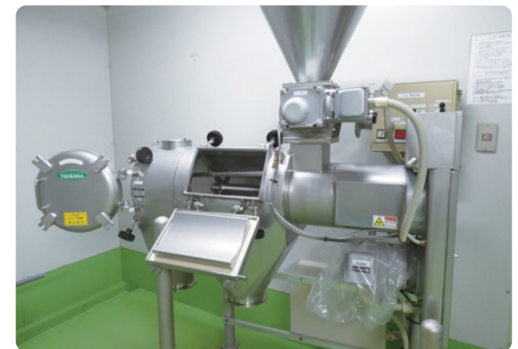
ラインシフター(種麹の耐久性向上を目的に使用する装置)
