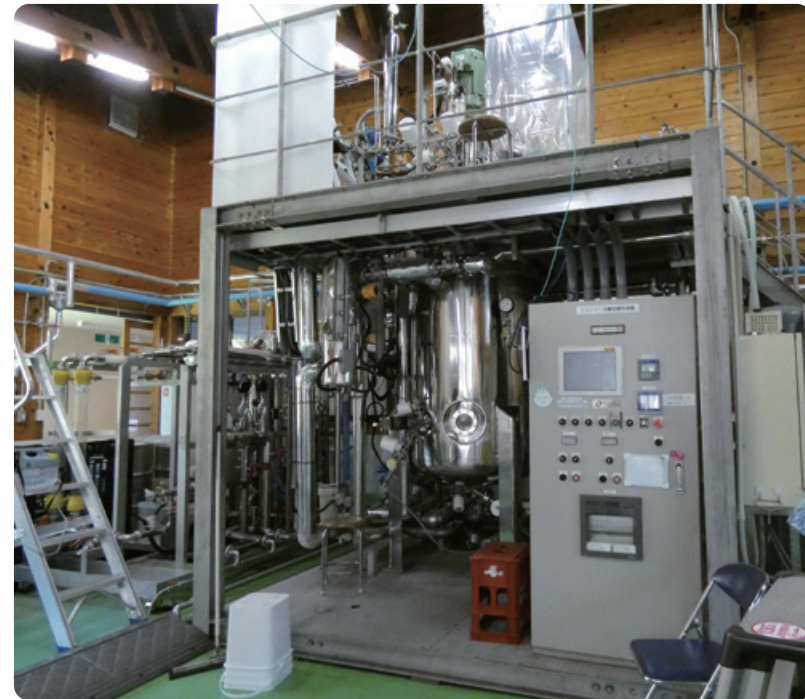
導入したジャーファーマンター(液体連続培養タンク)
