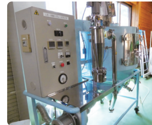
スプレッドライヤー(液体を粉末にする装置)
