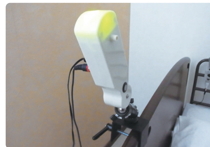
離床感知時の筐体部分(点滅で離床を通知)
