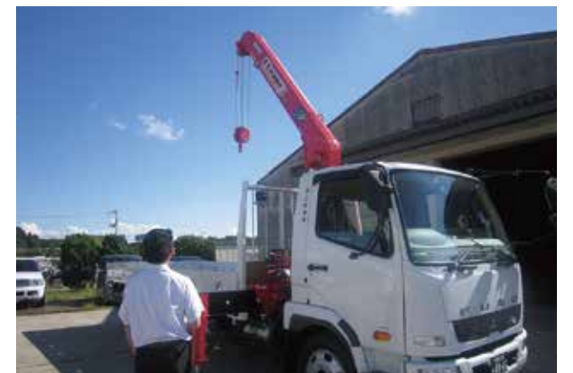
ユニッククレーンを取り付けたトラック
