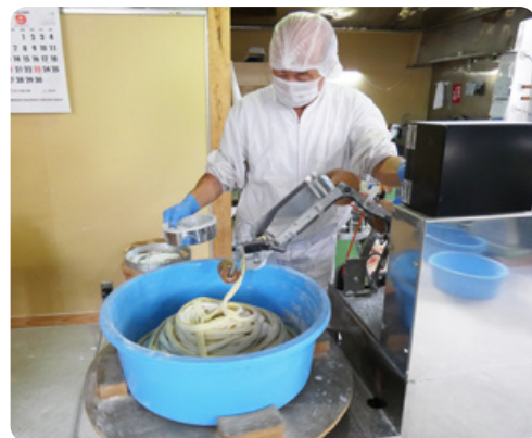
麺線自動巻入機(ひも状の生地を巻き取る機械)
