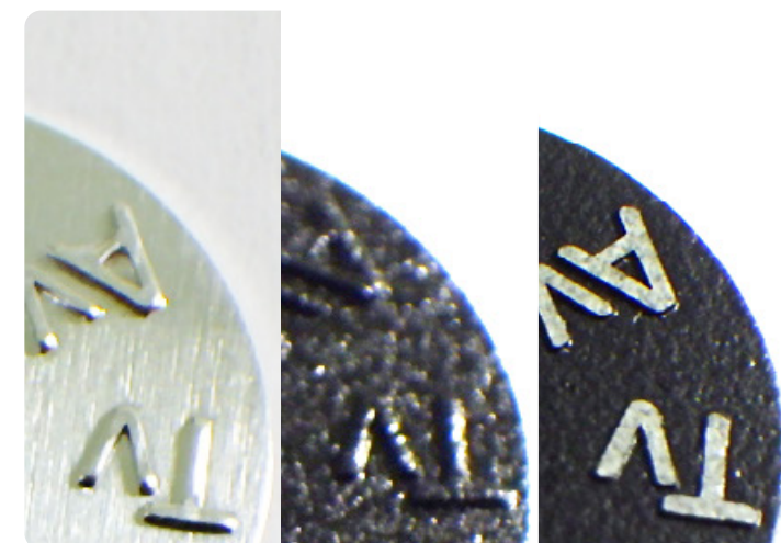
左からプレス→潤滑塗装(黒塗り)→ダイヤモンドカットを行った例
