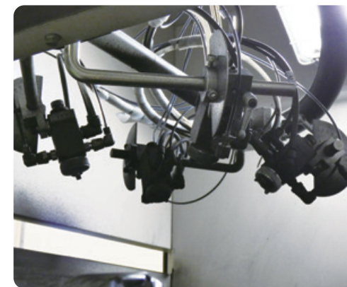
自動塗装装置の塗出部分(4本のガンから塗布)
