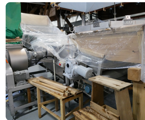
蒸し上げた酒米を適正温度まで冷やす高性能冷却機
