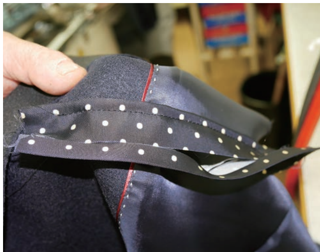
本縫自動玉縁縫機で作られたポケット裏側の部分
