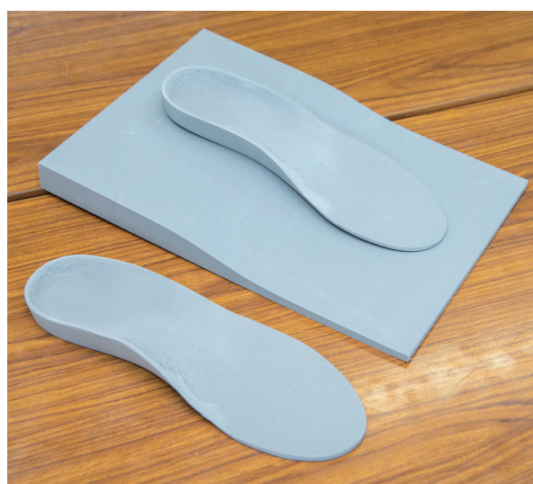
インソールの材料を切削機に入れ、自動で切削される(1足分)
