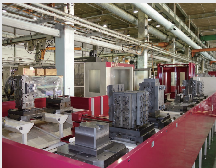
▲キャリア式12パレットプールライン。 パレットに載せた治具にワークをセットし横型マシニングセンタに自動供給する。
