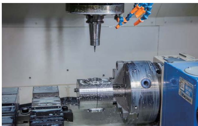
INDEXを搭載しており、多面加工が可能になった
