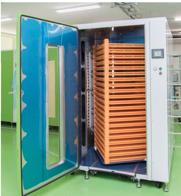
庫内のコンテナを回転させ温度・湿度を均一にする
