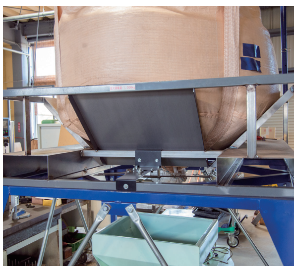
フォークリフトで、フレコンバックをフレコン用フレームの上にのせ、土や米、肥料などの排出作業を行う
