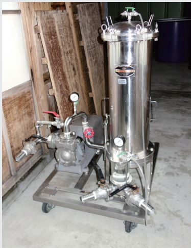
▲上槽後に使用する中空糸濾過機。 炭を使うよりも酒の旨味が残る。
