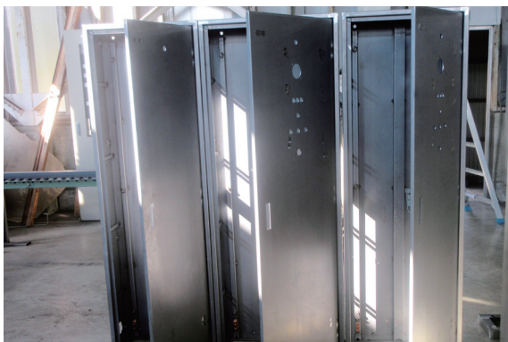
加工完成した機器取付パネル
