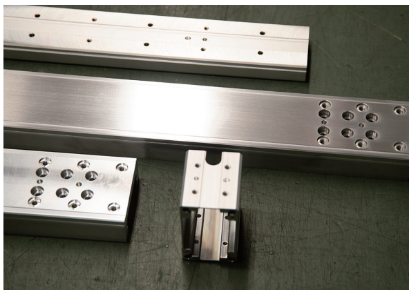
穴加工、タッピング加工など表裏加工の時間が短縮された
