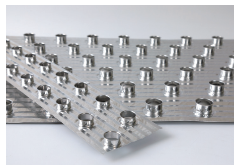
ハイカラーコンビネーション金型での試作品
