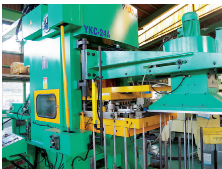
従来の圧入方式から拡管方式へ変更
