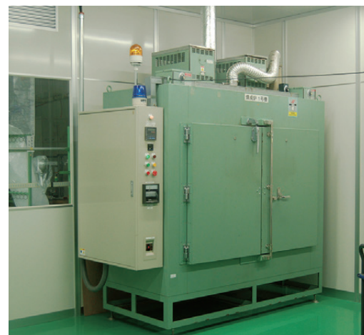
コーティングの塗装装置。膜厚が均一で、膜質が安定していることが重要。作業効率のいい治具立てに独自の工夫をしている
