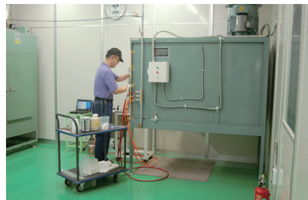
コーティングの塗装装置。膜厚が均一で、膜質が安定していることが重要。作業効率のいい治具立てに独自の工夫をしている
