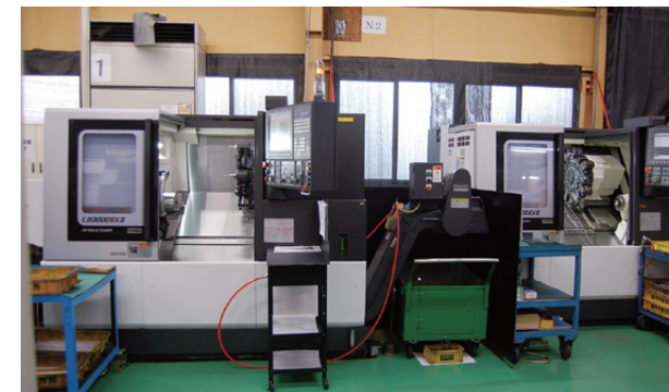
今回、ミーリング付きNC旋盤2台を導入。試作品のリードタイムを従来の半分程度に短縮するなど、十分な成果を得ている
