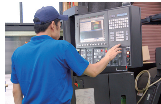
今までは専門用語でのプログラミングが必要だったが、3次元CADデータを使うことで、ビジュアルで設計を確認できる
