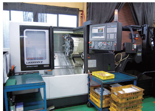
最新のNC旋盤を導入し、短納期化、3次元CADデータへの対応、加工精度の向上を目指した
